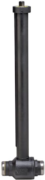
Válvula de bola a enterrar totalmente soldada en acero A105/WCB, paso total, soldadura a tope la cabeza B.W., realizada de acuerdo con UNI 9734 y EN 13774, Intercepción de gas natural, con extensión del vástago acortado directamente en el sitio de instalación según sea necesario.
