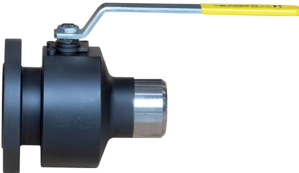
Kugelhahn aus C-Stahl ASTM A105, reduzierter Durchgang, nach UNI 9734 und EN 13774 Vorschriften , einerseits Anschweissenden andererseits Flansch nach ANSI150, Baulänge nach B16.10.
