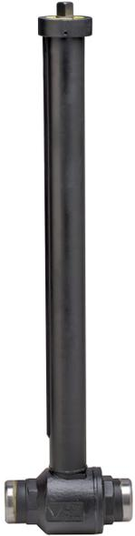
Kugelhähne für unterirdischen Einbau, aus Stahl ASTM A105/WCB, voller Durchgang, Anschweißenden, nach UNI 9734 und EN 13774, geeignet für Erdgas, Schaltwellenverlängerung im Einbauort je nach Bedarf abkurzbar.
