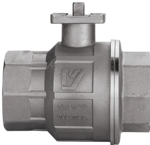
Edelstahlkugelhahn aus AISI 316-CF8M Ausgestattet mit V-Ball zur Druck- und Durchflussregelung, Innengewinde, mit Aufbauplatte nach ISO 5211, mit vollem Durchgang, antistatische Ausführung.
